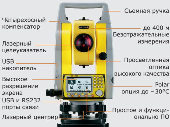
GeoMax Zoom20 Pro оборудован защищенным от атмосферных осадков USB портом, который обеспечивает быструю, простую и надежную передачу данных между Zoom20 Pro и ПК, а также другими тахеометрами. Сочетание большого дисплея с высоким разрешением и интуитивно понятного графического интерфейса позволяет выполнять такие повседневные задачи как съемка, разбивка, быстрее и точнее, чем когда бы то ни было.
